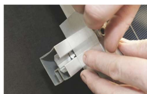
E. Gänga i ändklämma och insexskruv för hand, för att undvika korsgångning.
