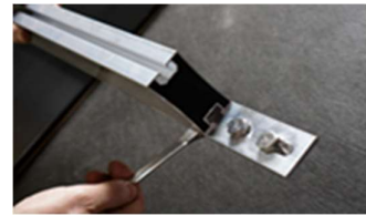
F. Fäst profilförbindare med totalt 4st. T-bult. Skruva fast profilförbindare med flänsnutt. Skarva aldrig skena över gavel.
